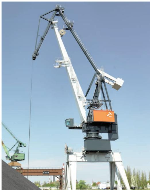
Der elektrisch angetriebene Kran ist schienengebunden und mit einem 4-Seil-Greiferhubwerk für den Schüttgutumschlag ausgerüstet. Durch eine am Lenkersystem angebrachte Kabeltrommel mit Stromzuführungs – und Steuerkabel können weitere Umschlagsvorrichtungen wie Teleskopspreader, Motorgreifer, Lasthebemagnete, Coilzangen und ähnliches betrieben werden und machen den Kran zu einem Vielzweckkran.
