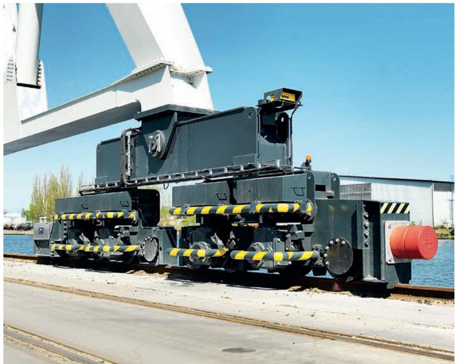
↑ Vollelektrische Schienenfahrwerke: sicher und effektiv
