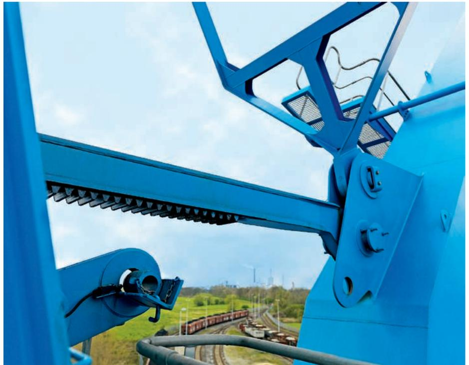
↑ Zuverlässig und sicher – Zahnstangenwippwerke
