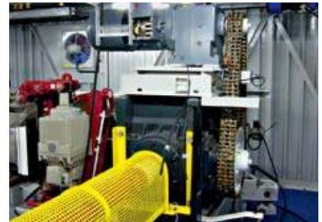
↑ Durch den Notantrieb kann der Spreader auch bei Stromausfall geborgen werden
