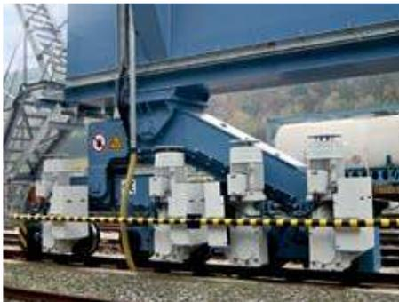
↑ Portalfahrwerk mit Einzelradantrieb
