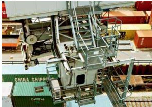
↑ Die Drehlaufkatze dient der korrekten Positionierung der Container auf Bahn und LKW. Hier lässt sich die Fahrerkabine außerdem horizontal verschieben
