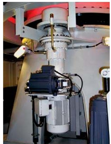
↑ Der Drehantrieb bringt die Katze präzise in den vorgewählten Drehwinkel
