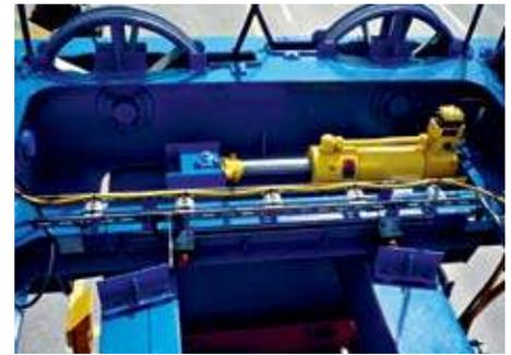
↑ Korrekturbewegungen des Spreaders werden auf der Kopftraverse hydraulisch ausgeführt
