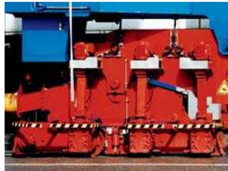
↑ Durch höhergelegte Motoren können die Fahrwerke ohne Schaden überfluten
