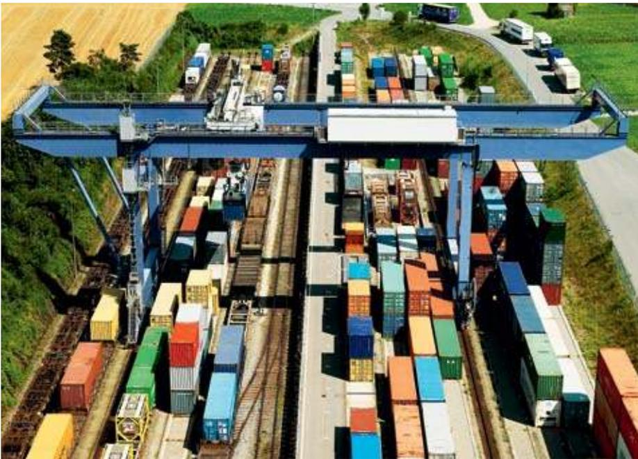
↑ Die robuste Kastenträgerbauweise ist perfekt auf die Arbeitsweise des Terminal Server abgestimmt
