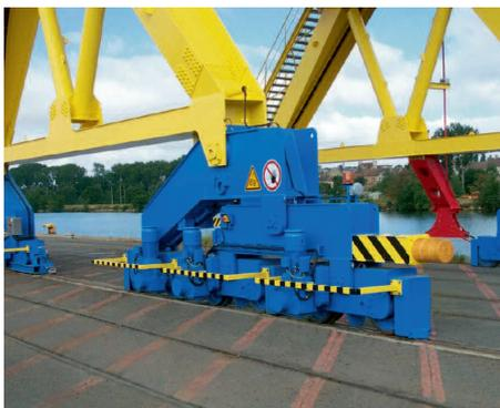
↑ Fahrwerke aus dem Baukasten
