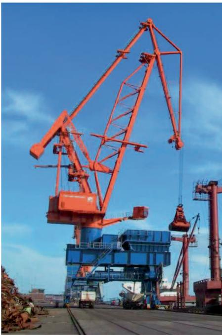
Mittlere Leistung mit 63-t-Greiferhubwerk: 1.750 t/h Kohle mit Dichte 1 t/m<sup>3</sup>
