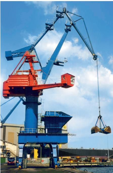
Mittlere Leistung mit 16-t-Greiferhubwerk: 600 t/h Kohle mit Dichte 1 t/m<sup>3</sup>
