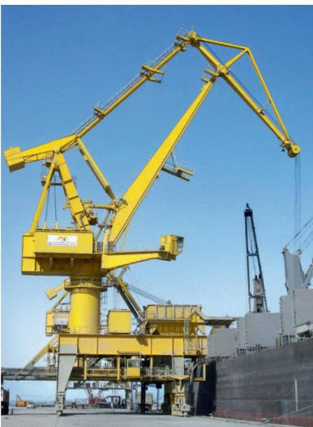
Mittlere Leistung mit 40-t-Greiferhubwerk: 1.250 t/h Kohle mit Dichte 1 t/m<sup>3</sup>
