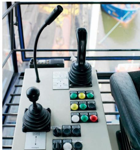
↑ Übersichtliche und ergonomisch günstige Anordnung der Bedieninstrumente am Kransteuersessel
